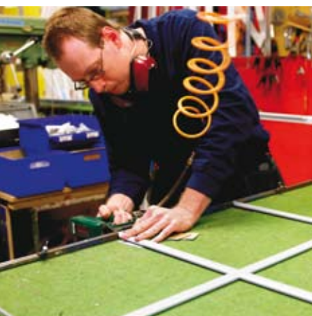
Jimmie monterar spröjs i isolerglas.
