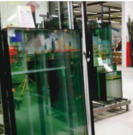
Isolerglas färdiga för emballering.
