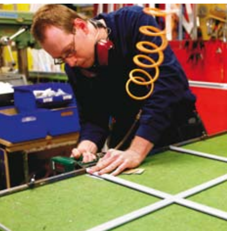
Jimmie monterar spröjs i isolerglas.
