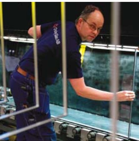
Roger positionerar list för isolerglas.
